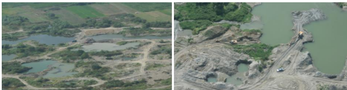
Figura 29. Ndryshimi i rrjedhës kryesore të lumit për shkak të nxjerrjes së materialit inert nga lumenjtë; Burimi: Raporti për Gjendjen e Ujit – AMMK, 2015
